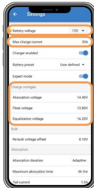
Aplicación VictronConnect mostrando los ajustes de tensión de la batería (sistema), corriente de carga y tensiones de carga.
